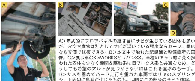
A>年式的フロアパネルの継ぎ目にサビが生じている固体も多いが、穴空き腐食は別としてサビが浮いている程度ならセーフ。同店なら安価で修復できる。B>本文中で触れた記録簿と整備箇所画像。C>展示車のKeiWORKSとランバSS。車種のキャラ的に荒く扱われた固体も少なく機関&駆動系は旧ワークス系と共通なため、どうしても希望のアルトが見つからない時はこれを選ぶのも一手。D>サスを固めてハード走行を重ねた車両ではリヤのスプリングシート周辺に亀裂が生じたものも。同時にこの部分のサビも確認。
