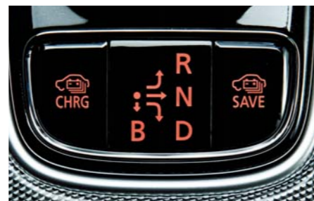
走行中でも駆動用バッテリーへ充電したり、電力の使用量を抑制するといった制御をスイッチで行なえる
