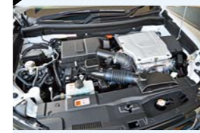
2.0Lエンジンは走りにも発電にも威力を発揮する。小型軽量とすることで車重増を抑えている
