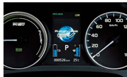
右が速度、左はエネルギーの使用/回生の度合いを表示するパワーメーターを配置。中央の4.2インチ大型カラー液晶ディスプレイには、さまざまな情報をカラーで見やすく表示
