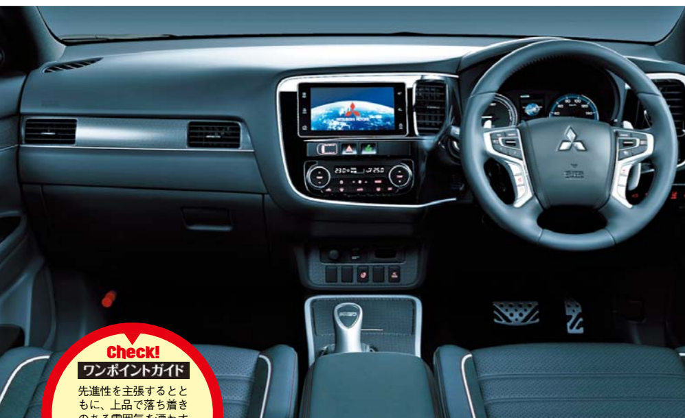
右が速度、左はエネルギーの使用/回生の度合いを表示するパワーメーターを配置。中央の4.2インチ大型カラー液晶ディスプレイには、さまざまな情報をカラーで見やすく表示
