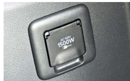
AC100Vコンセントはフロアコンソール背面と荷室内に備わる。最大出力1500Wで、消費電力の大きい家電品が使える
