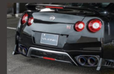
アンダーディフューザー部分だけでなく、リヤランプまわりまで被うバンパースポイラー。チタンマフラーカッターもブレーン製
