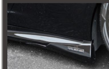
前/後端部のみをフィン形状にカバーするサイドマッドガードスポイラー。VLENEのオーナメントプレートが誇らし気だ
