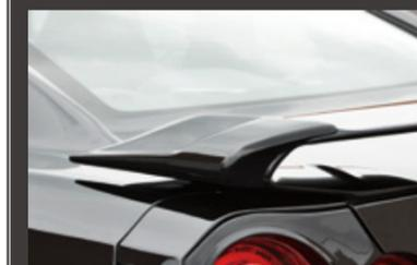
ワイド化に合わせて、リヤフェンダー後端部のリフレクターが備わる部分にもカバー（製品名サイドパネル）を製作
