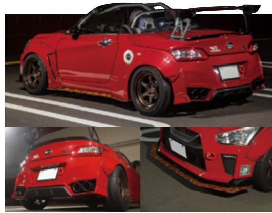
一世を風靡したリバティウォークのオーバーフェンダーキットにフロント、リヤまでリバティで武装。マフラーはJワークスの4本出しをセッティングで排気もバッカリだ
