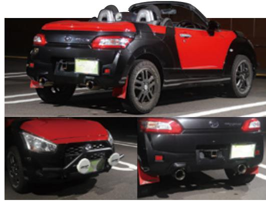
ジムニーのバンパーガードをワンオフで装着し、キャストアクティバの足まわりを移植して車検対応リフトアップを実現。ジムニーシエラのヒッチもワンオフで取り付けます。多車種用カスタムもお手のものになります
